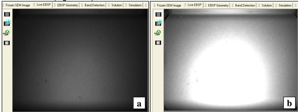
Figura 1 – Padrão de EBSD (a) com ruído de fundo (“background”) na condição ideal (sem saturação) e (b) saturado com uma mancha branca (“timing per frame” alto).
